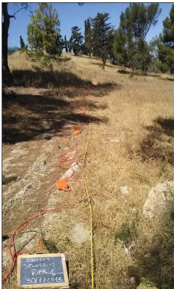
ricezione; la conversione A/D avviene già dal primo metro di cavo: il sistema permette pertanto di eliminare molte fonti di disturbo dovute al trasferimento del segnale ed è inoltre dotato di un sistema di filtraggio in tempo reale, da un hardware complesso, che comporta un anello di regolazione con diversi passaggi di digital signal processing.
