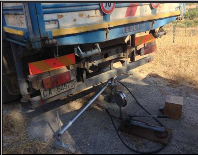
Figura 36 - Esecuzione della Prova di Piastra [P1]
