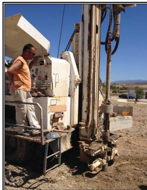
Figura 18 - Esempio di Prova discontinua S.P.T.
