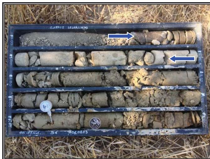
Figura 28 - Livello eluvio-colluviale limoso argilloso
